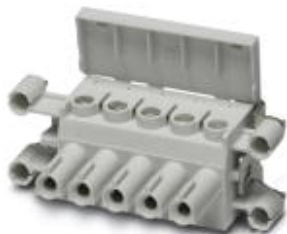
Wkładka stykowa ze zintegrowaną ramą tulejową, konstrukcja VC 3, 4-polowa + PE, 690 V / 70 A
